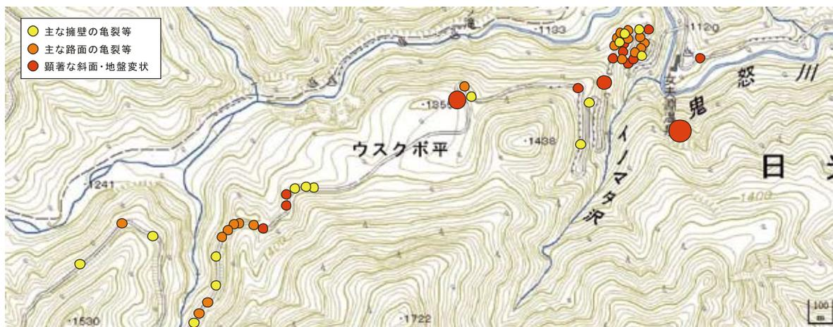
図-7 2013年2月25日栃木県北部を震源とする地震による主な斜面・地盤変状の分布 (若井 (2013))
